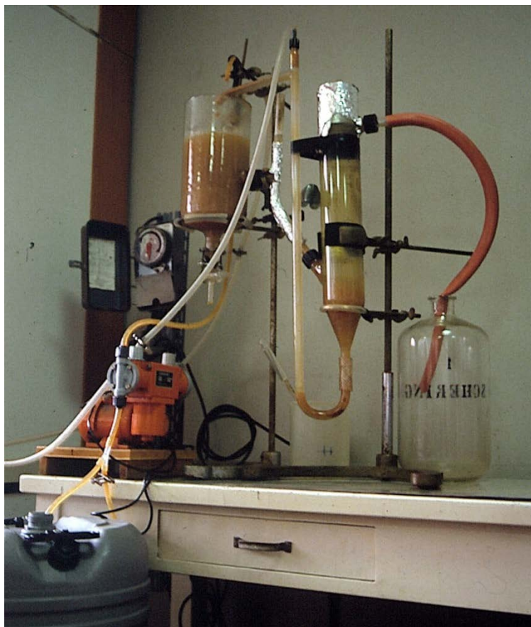
Impianto a fanghi attivi (FA) convenzionale
